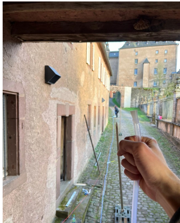
Höhenbestimmung per Schlauchwaage
